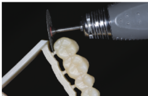
Rimozione dei supporti
